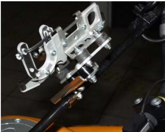
Montagebeispiel: Verlegungsadapter mit montiertem GPS-Halter.
